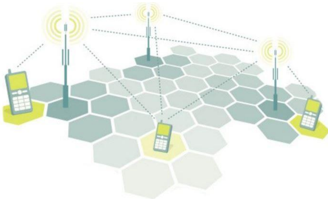
Schema di funzionamento di una rete di telecomunicazione cellulare
